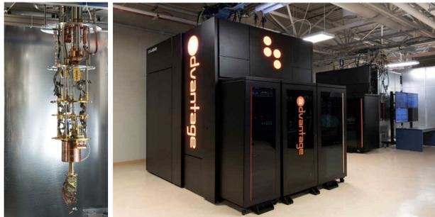
Fig. 1. D-Wave Advantage quantum annealer
